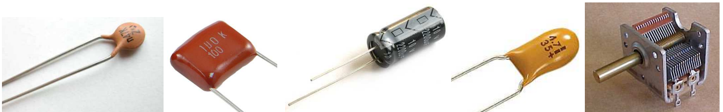
Varios ejemplos de condensadores (cerámico, de poliéster, electrolítico de aluminio, electrolítico de Tántalo, y condensador variable).
